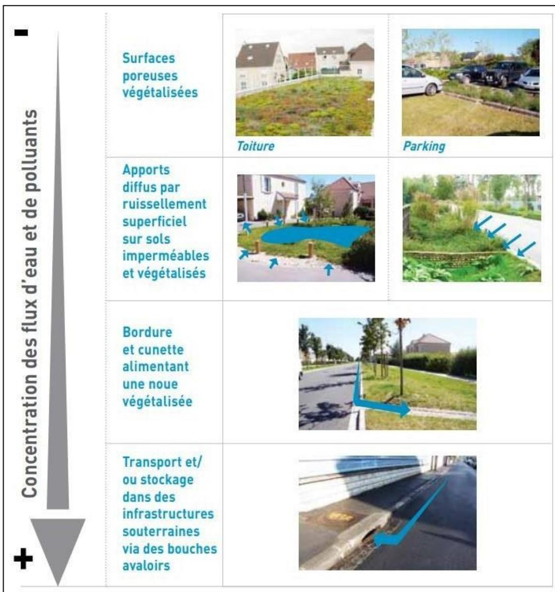
Figure 10 : Influence de la conception sur la concentration des flux d'eau et de polluants dans les ouvrages de gestion des es de gestion des eaux de ruissellement (source : AESN)
